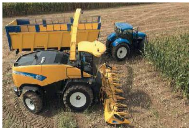
Fig. 22: Ensiladora autopropulsada modelo FR9060 de 578 hp y cabezal rotativo modelo FI440 para 8 surcos en cosecha de maíz.
