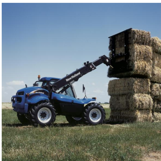
Fig. 15: Manejo y acomodo de pacas después de ser confeccionadas. Equipo: cargador telescópico New Holland
