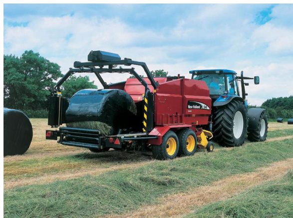
Fig. 19: Empacadora de rollo tipo “COMBI”, que empaca y envuelve el forraje con plástico en una sola operación.
