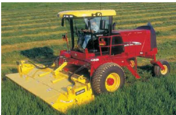
Fig. 10: Segadora acondicionadora autopropulsada modelo H8060 de 190 hp con cabezal de discos modelo 750HD y ancho de corte de 4.70 m.
