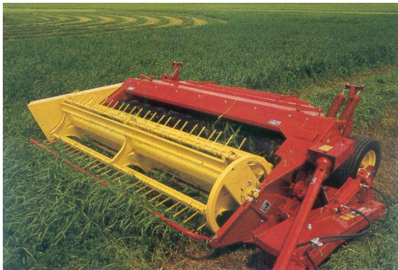
Fig. 9: Segadora acondicionadora de corte alternativo modelo 488. Ancho de corte 2.80 m.
