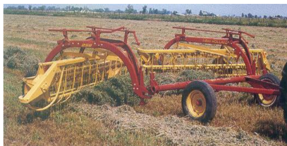
Fig. 11: Rastrillos hileradores modelos 258 y 260 montados en un tándem tipo “ V “ con un ancho de barrido de 6 metros.
