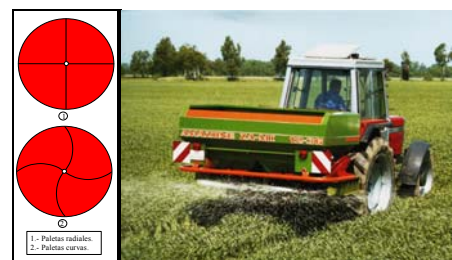
Figura 16.- Nervaduras en discos y detalle de salida de abono.
