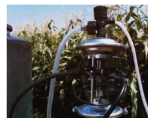
Figura 38.- Bomba inyectora de abonos.
