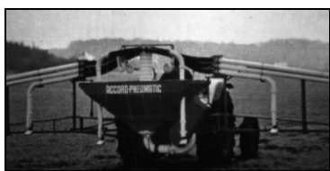
Figura 22.- Distribuidor neumático con dosificador de orificio regulable.
