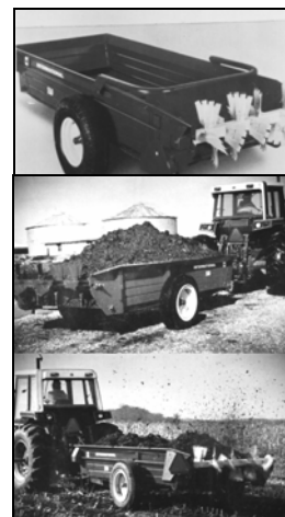
Figura 29.- Sistema de reparto de tornillo sin fin.
