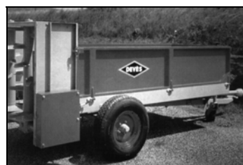
Figura 25.- Remolque repartidor de estiércol.
