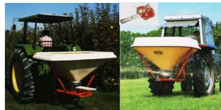
Figura 14.- Abonadora pendular con dosificador de ventana.
