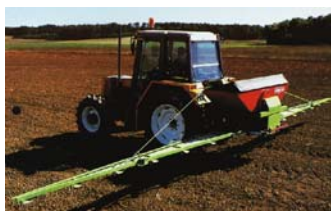
Figura 23.- Distribuidor neumático con dosificador de cilindro dentado.
