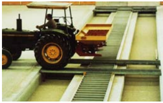
Figura 17.- Banco de ensayos de abonadoras.
