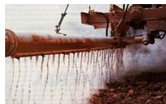
Figura 10.- Abonadora con dosificador de tornillo sin fin.
